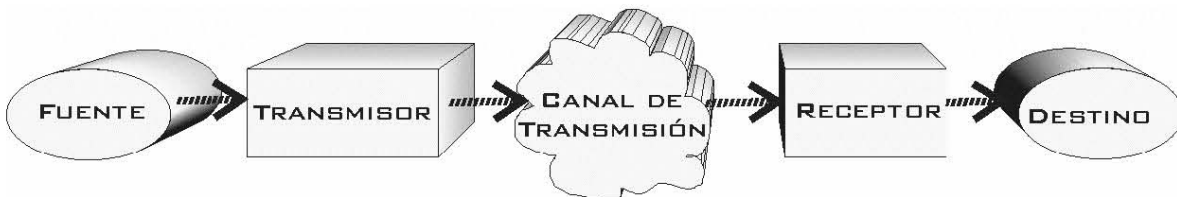
Figura 1.1 Elementos Fundamentales de un Sistema de Comunicaciones.
