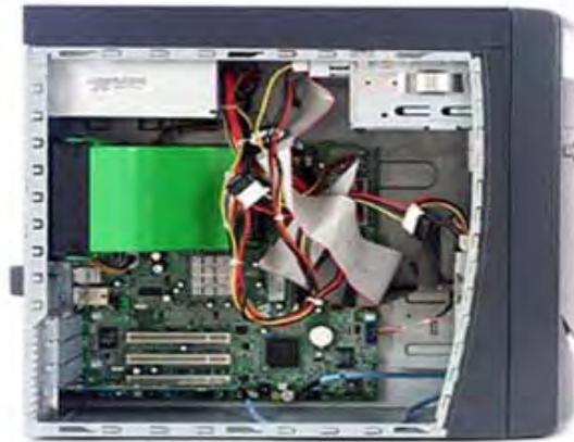
Figura. 3.3 Vista interna equipo Dell OptiPlex GX 270
