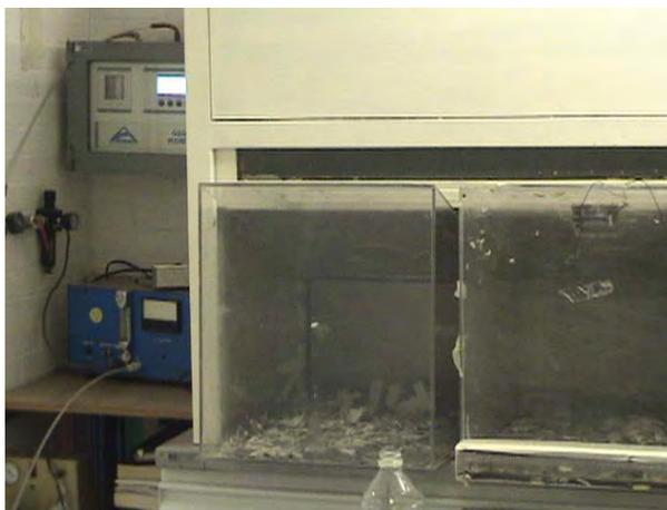
Figura 7.4 Equipo generador de ozono y cámaras con ozono
