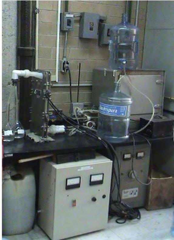
Figura 7.2 Sistema de obtención de agua electrolizada
