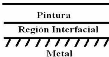
Figura 3. Representación esquemática de los elementos principales del sistema metal-pintura<sup>(17)</sup>.
