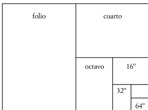
Al doblar el pliego de 70x95 cm cuatro veces, se obtiene el tamaño que se desea para el libro, contando con los rebases que se requieren para las pinzas de la máquina de impresión y las áreas de corte; al desdoblarlo se tendrán 16 rectángulos por cara, es decir, 16 páginas por lado, y 32 páginas por pliego. Así, se estará hablando de un libro en dieciseisavo.
