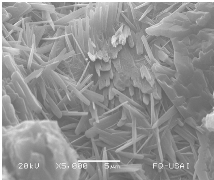
Figura 40. Micrografía SEM de una muestra sin lavar en la que se pueden ver los “nanocinturones” que son probablemente formados a partir de bloques más grandes.
