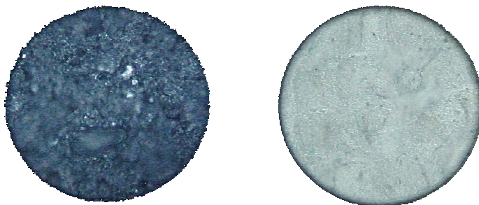
Figura 30. Imágenes microscópicas de a) \text{TiO}_2 sol-gel/10%NC y b) \text{TiO}_2 com/10%N. Ambos horneados a 300^\circ\text{C} /aire/10 min (x20).
