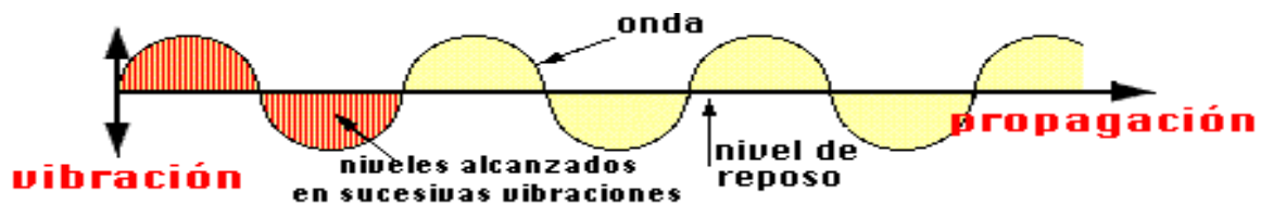
Figura B.1 Onda que se propaga en dirección perpendicular a la de vibración
