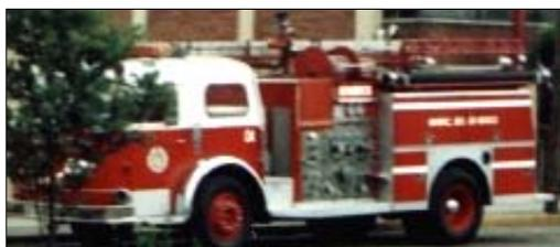
**Carro cisterna o Autotanque.-** Cuenta con una bomba de capacidad pequeña y una línea corta de mangueras ya conectadas. Su función es como una autobomba de uso inmediato con capacidad de 10,000 litros con bomba autocebante de 12 H.P. Su maniobra es rápida, combate con eficiencia pequeños incendios y controla el fuego mayor mientras el equipo mayor y menor entra en acción.
