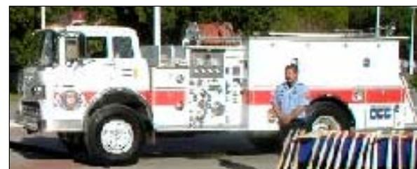
**Unidades p/ líquidos inflamables.-** Se destinan para ser utilizadas en incendios de vehículos, tanques y en aeropuertos. Están equipadas con contenedores de espuma, niebla, bióxido de carbono y equipo especial de entrada por "*cable de rescate*".
