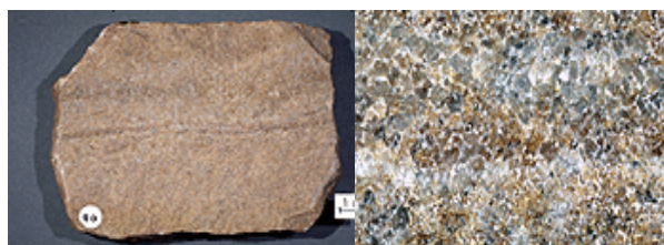
Figura 1.2.7 Fragmento de arenisca y una vista en lámina delgada.
