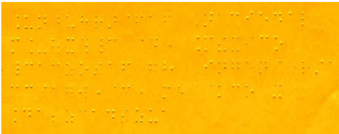
Figura 6.1 En código Braille impreso con el prototipo funcional de la impresora:
