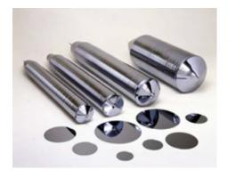
Fig. 1.6 Sustratos de Si a partir de los cuales se realizan los cortes para la obtención de las obleas.
