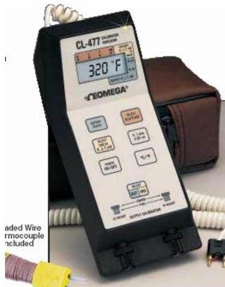
Figura 4.2. Calibrador para Termopares.
