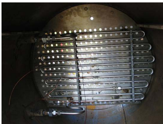
Figura 2.9. Sección de prueba con termopares instalados.
