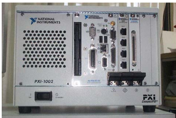
Figura 2.3. Controlador y Tarjetas de expansión PXI.
