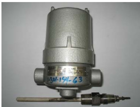
Figura 2.7. Sensor y transmisor de nivel.
