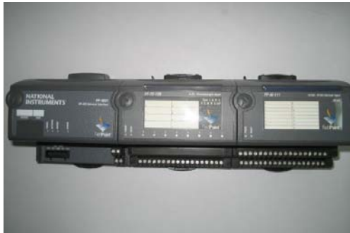
Figura 2.4. Banco de módulos FieldPoint
