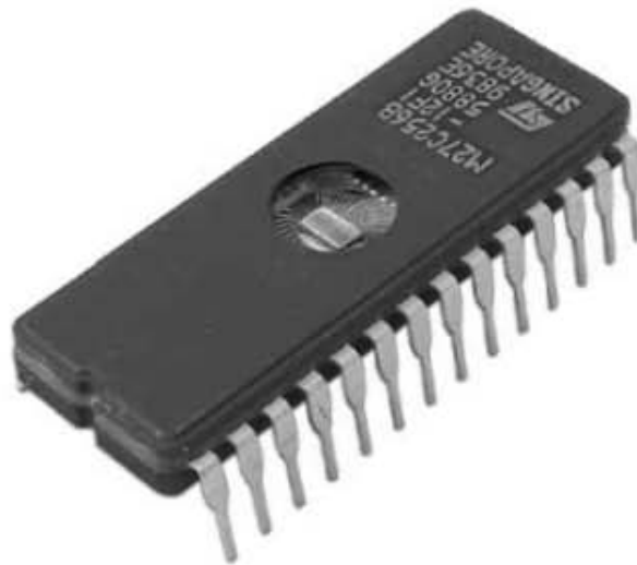
Figura 6.5. Memoria M27C256B -12F1 utilizada para almacenar SOFMIN
