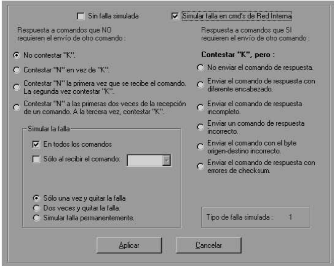
Figura 6.17. Ventana que utiliza SOFDEVO para la simulación de cualquier falla en Red Interna.
