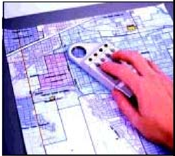
Figura 3.3-2 Vectorización mediante tableta digitalizadora.
