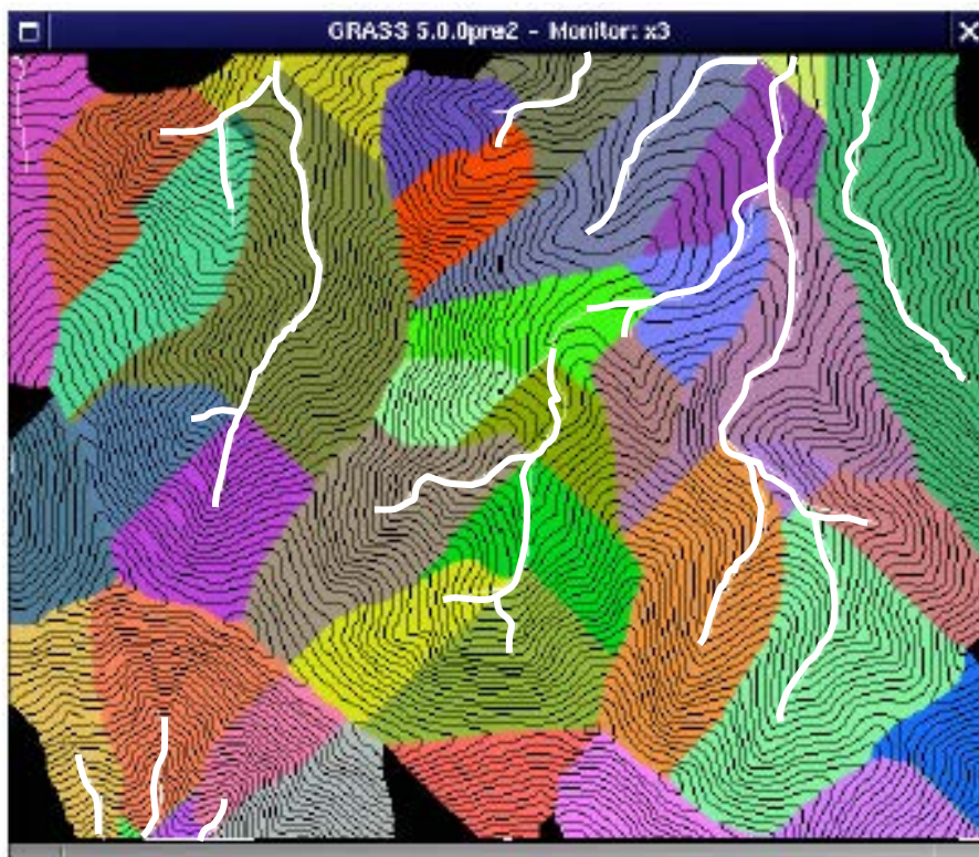
Figura 3.2-18 Obtención de cuencas y redes de drenaje
