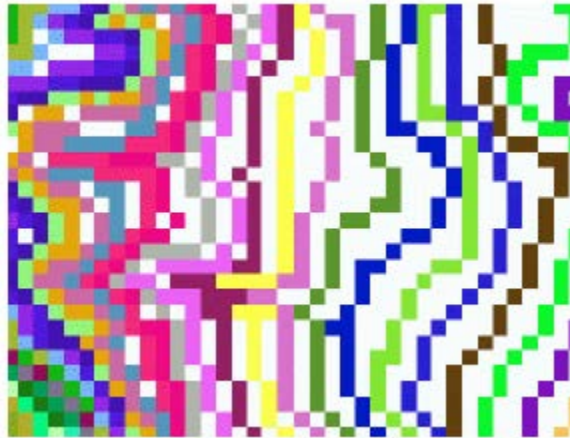
Figura 3.2-13 Curvas de nivel rasterizadas con tamaño de píxel demasiado grande
