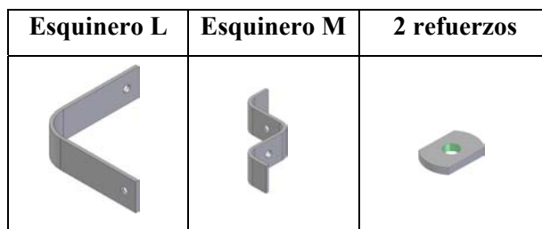
Figura 3.7 Componentes del Esquinero
