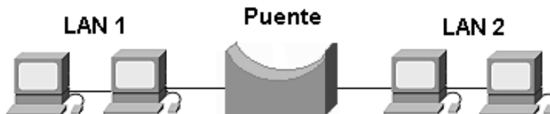
Figura 2.13 Unión de dos redes mediante un puente
