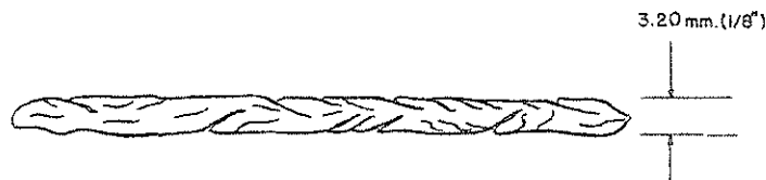
Figura 4.12 Dimensión del rollo para determinar el Límite Plástico
