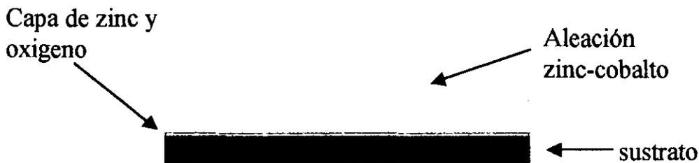
Fig. II.1: Representación esquemática de la composición de un recubrimiento de zinc-cobalto
