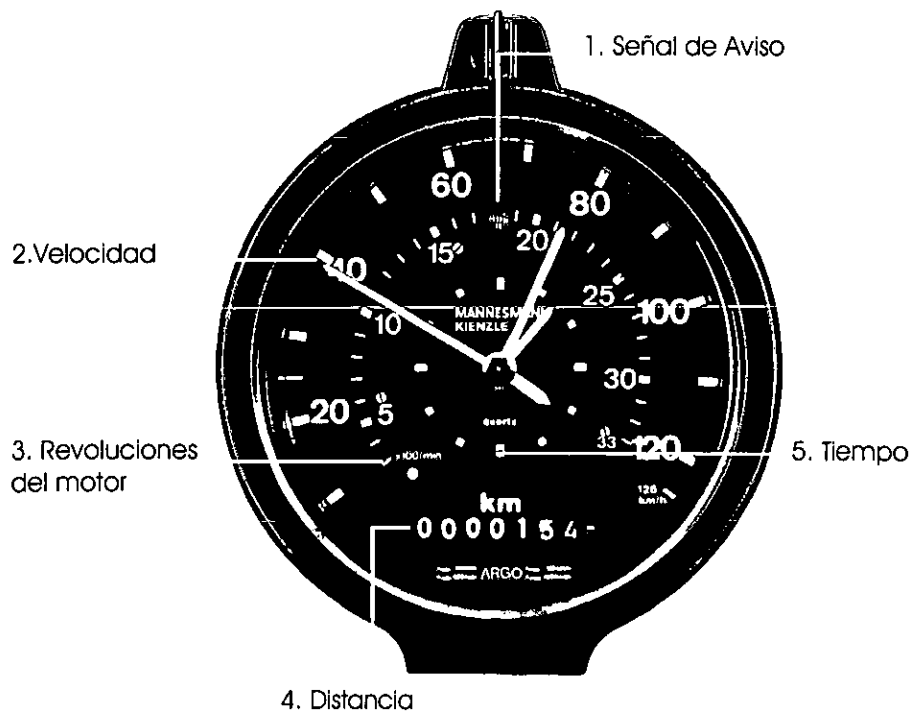
Fig. 11 TACÓGRAFO. Información durante la conducción
