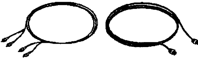
FIGURA 5.7 PACH CORDS: DE FIBRA OPTICA (IZQUIERDA), CABLE UTP (DERECHA)
