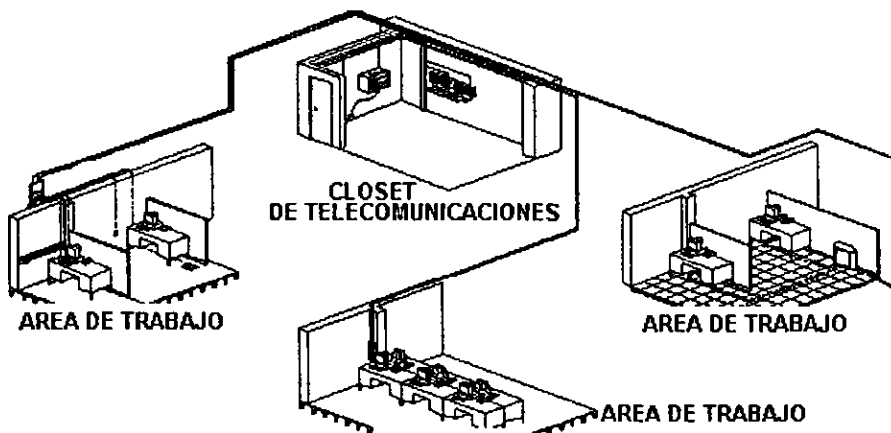
FIGURA 4.7 CONEXIÓN DE LOS NODOS CON EL CLOSET DE TELECOMUNICACIONES.
