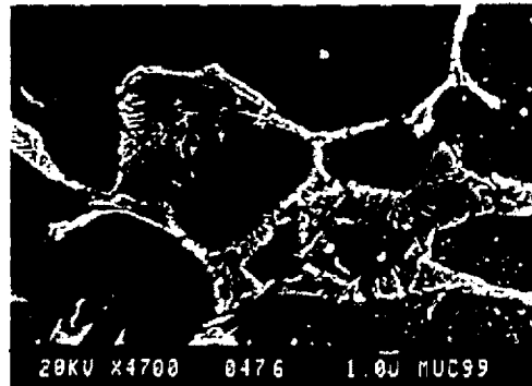
Foto 5.18: Se aprecia el eutéctico de Al-Si en los límites de grano.
