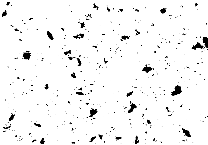
Foto 5.15: Baño fundido, zona central del cordón de soldadura. Muestra con estructura dendrítica. También contiene porosidad interdendrítica.
