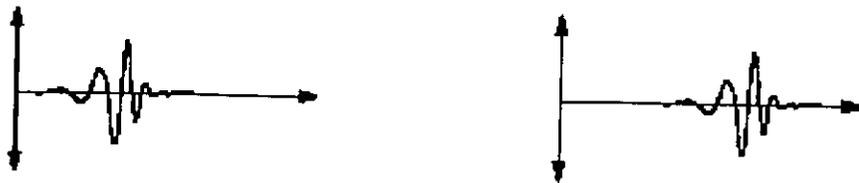
Fig. 5.11 Efecto de corrimiento  $\psi(t) \rightarrow \psi(t-k), k > 0$
