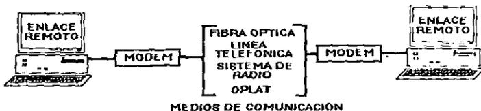
Figura 1.3. Interconexión entre equipos locales y equipos remotos.
