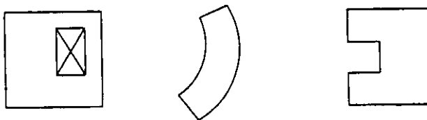
FIGURA 3.10 formas asimétricas en planta que son indeseables por tender a producir vibración torsional.
