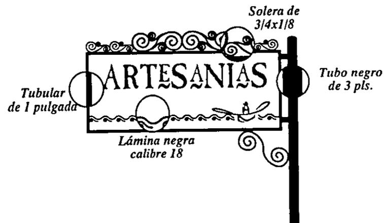
El señalamiento que se propone en este manual, se compone de tubo negro de 2 pulgadas y 1 lámina negra calibre 16, la cual lleva un marco de tubular de 3/4 a manera de soporte. Así pues el ornamento de la parte superior, e inferior (de 2 de los tipos de señalamientos) será de solera de 1/2 x 1/8.
