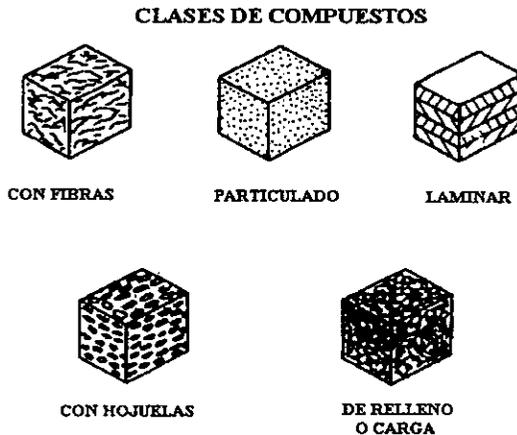
**Figura 2.6** Clasificación de los compuestos en base al refuerzo.
