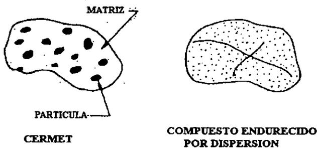
**Figura 3.1** Tipos de compuestos reforzados con partículas.
