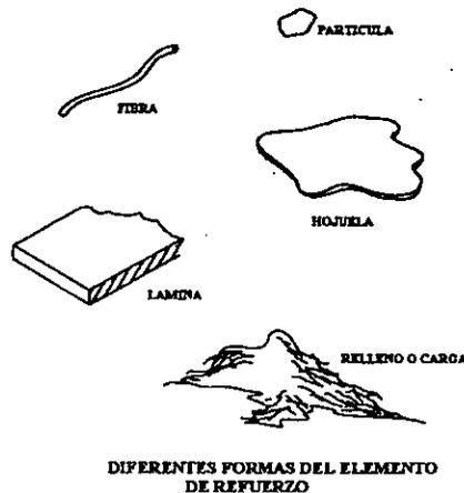
Figura 2.3 Posibles geometrías de la fase de refuerzo.
