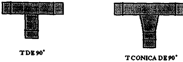
Figura 8.9) Derivaciones en T de ductos cilindricos
