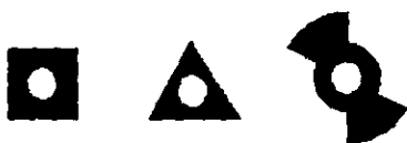
Figura 5.4) Terminales ( pads ) típicas usadas para puntos de dato o para indexar perforaciones.
