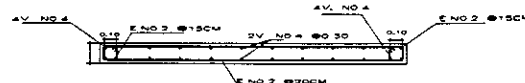
MC-1 SEPARAR AL DOBLE EN LOS 3/5 CENTRALES DE SU ALTURA LIBRE RECURRIMIENTO MINIMO DE LAS VARILLAS 2.5CM
