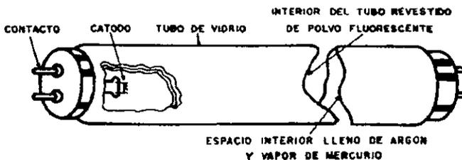
Figura 13. Partes Principales de una lámpara fluorescente
