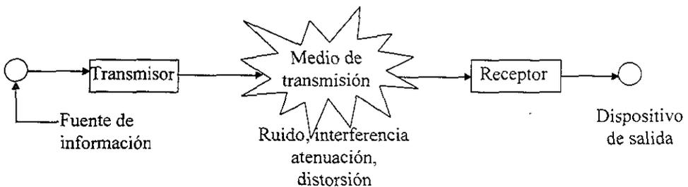
**Figura 1. Diagrama a bloques de un sistema de comunicaciones punto a punto.**
