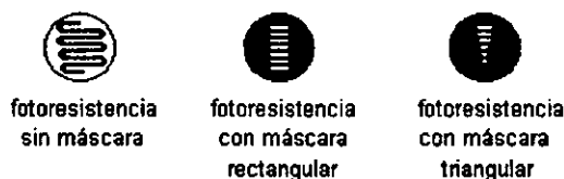
Figura 2.16 Fotoresistencias con diferentes máscaras para reducir la no linealidad en su respuesta.
