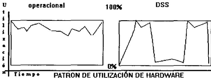
Figura I.7 Patrón de diferencias en la utilización de hardware en el procesamiento Operacional y DSS.
