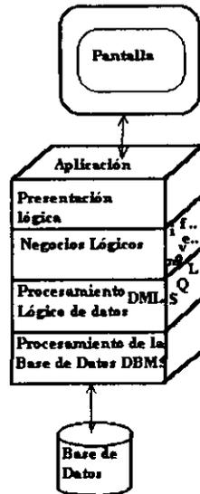
Figura: II.6 Componentes típicos de una aplicación.
