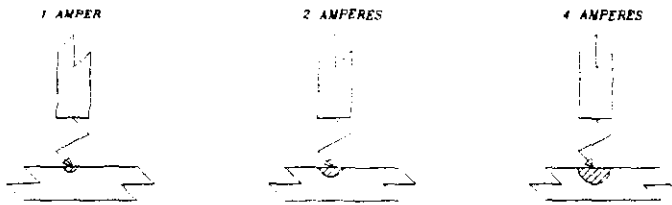
Figura 1.5.- Efectos de la corriente en la electroerosión.
