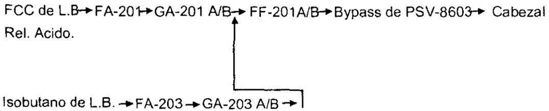
Al mismo tiempo sacar de operación, depresionar, drenar y barrer el circuito de regeneración de los secadores FF-201A/B.
